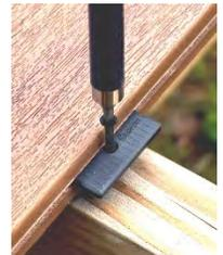
*Der Phantom-Universalclip hat eine Breite von 38 mm und ist darauf ausgerichtet, den gesamten Unterbalken abzudecken, um die Ästhetik der verdeckten Clips noch weiter zu verbessern. Bitte beachten Sie zudem, dass verdeckte Phantom-Universal-Terrassenclips einen Abstand von 5 mm zwischen den Dielenbrettern einhalten.*
